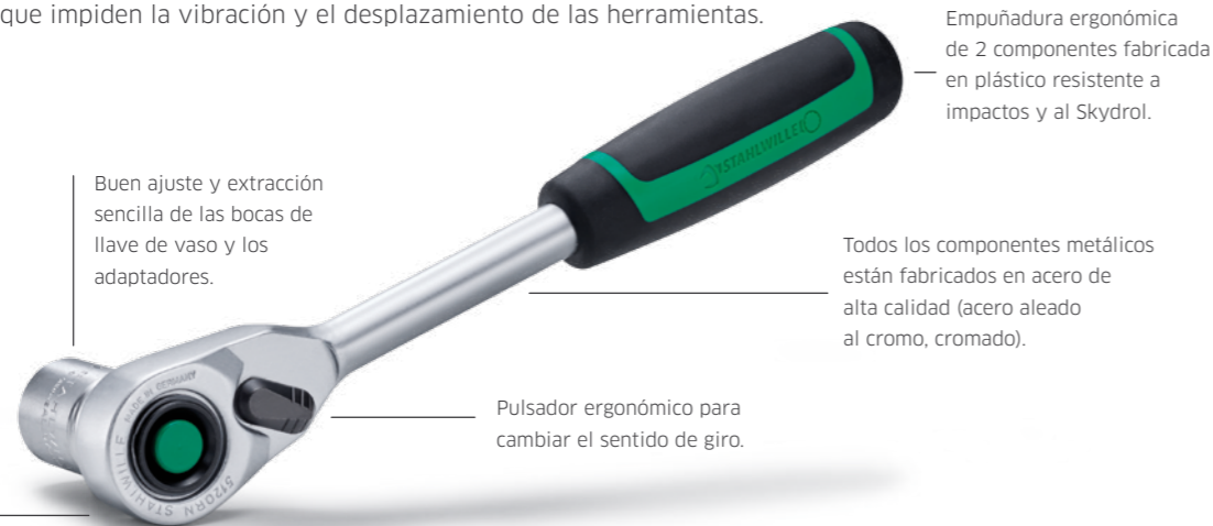
Los componentes de desgaste pueden sustituirse fácilmente mediante juegos de repuesto para carraca.
